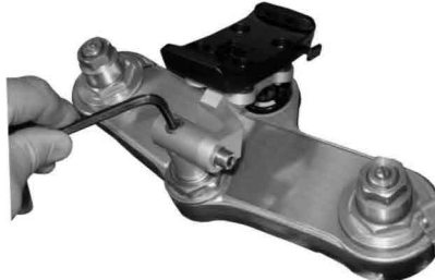
NL : Richt de steun uit en draai de bout aan. (max. 10Nm) GB : Straighten the mount and tighten the bolt. (max. 10Nm) D : Halter gerade ausrichten und die Schrauben mit max .10Nm anziehen.
