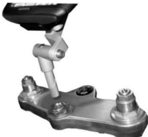
NL : Schuif de steun in het gat van de balhoofdpen. GB : Insert the mount into the hole of the steering stem. D : Halter in die Bohrung des Lenkkopfrohrs einführen
